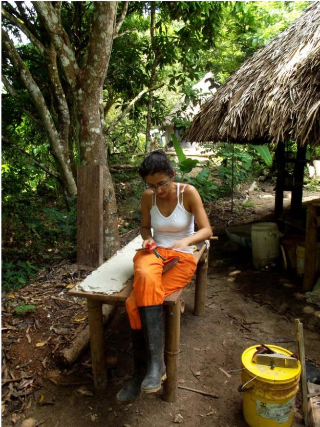
Limamos la rebaba que se generó en el borde por el corte en el plato metálico, donde va apoyado el plato de madera superior en el que se tornea la arcilla, para evitar posibles lesiones y para asegurar que el plato de madera se apoye en su totalidad y dar un giro limpio.
