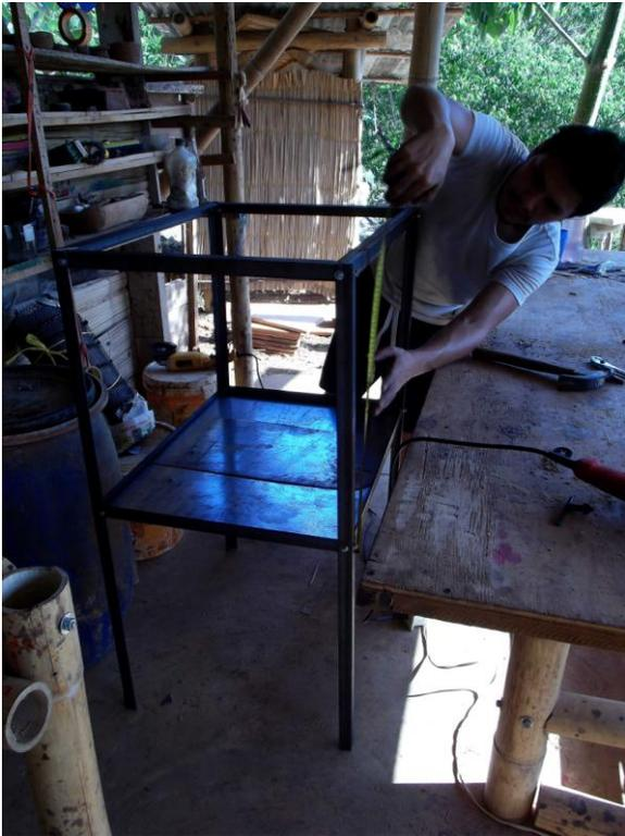
La estructura del horno se ensambló junto con las laminas de la parte inferior, para rectificar las medidas, la estabilidad, los ángulos y los espacios entre las uniones.
