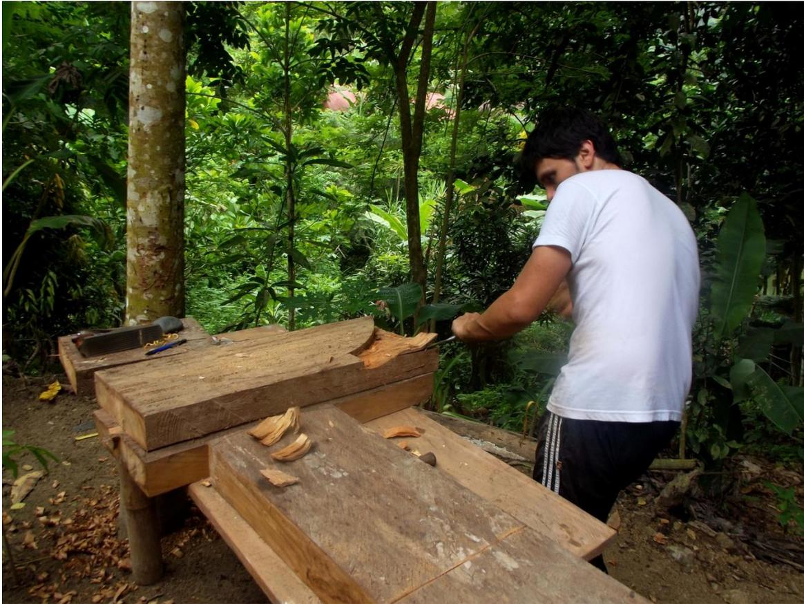
Agregar pegamento (colbón madera) a las superficies que entrarán en contacto, unir todos los trozos cortados, pulidos y tallados formando la circunferencia, reforzar la adherencia con tornillos lo suficientemente largos para que penetre los tablones cruzados. Generar bastante presión durante un tiempo prolongado para asegurar la adherencia de la madera y que no se desprendan con facilidad por el uso y el movimiento.
