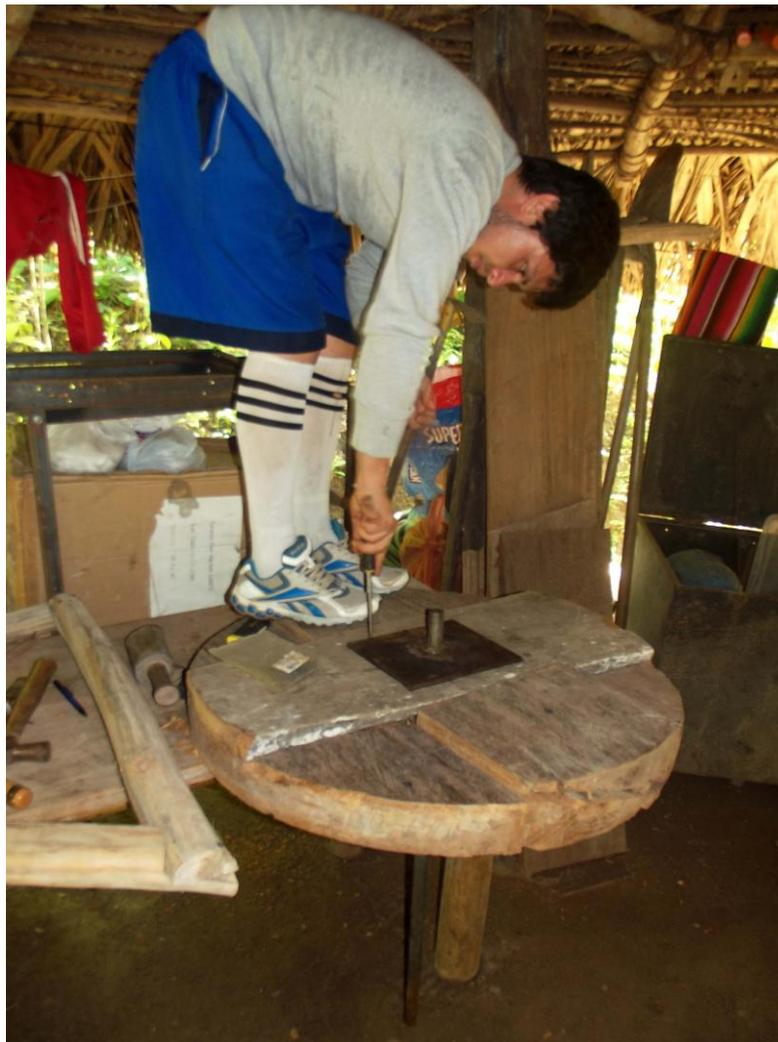
Se asegura el eje metálico al plato de madera con tornillos verificando que al girar el plato sobre su eje, el movimiento sea limpio, fluido y totalmente horizontal.
