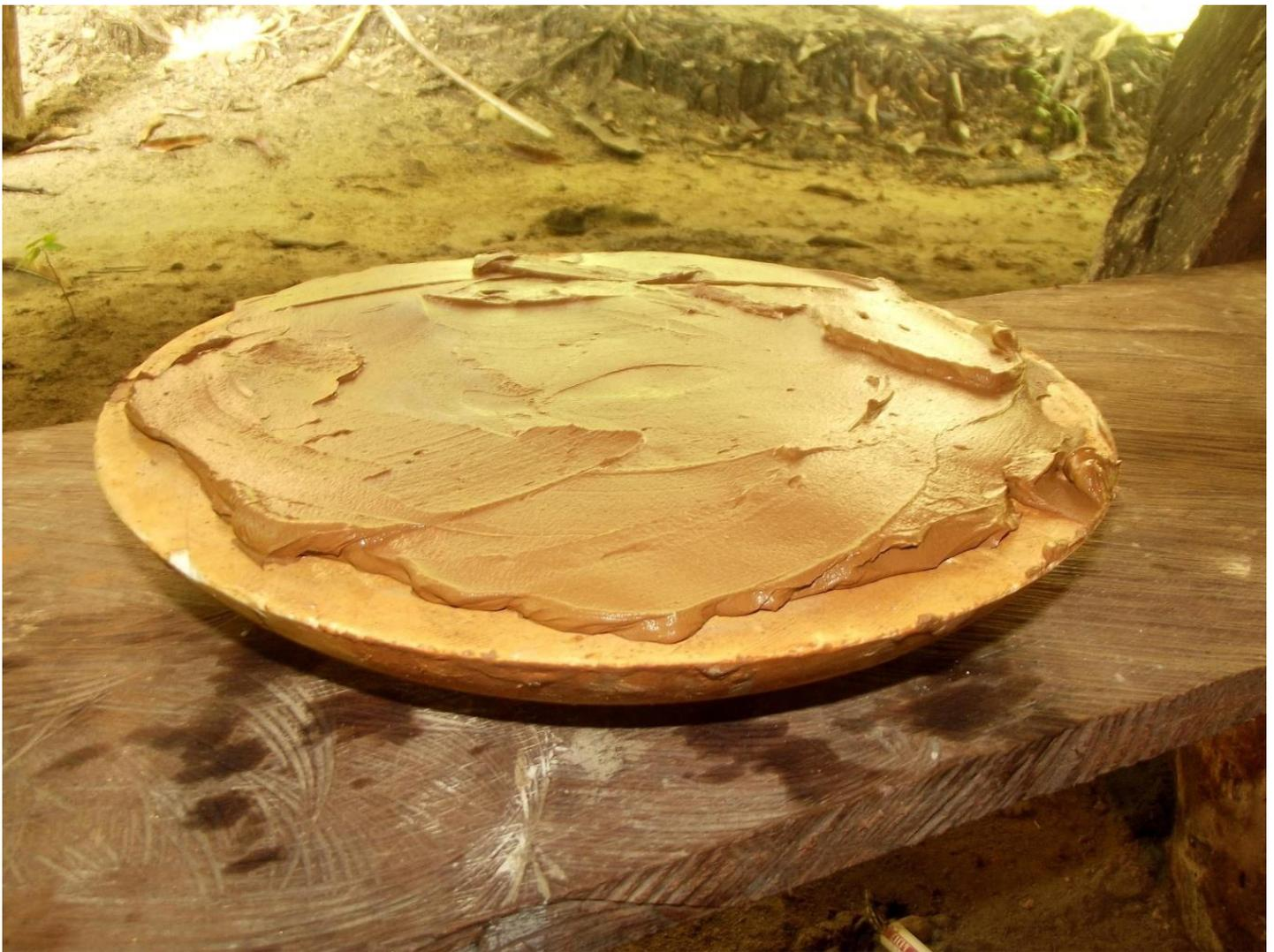
Arcilla húmeda en proceso de secado sobre el plato de yeso
