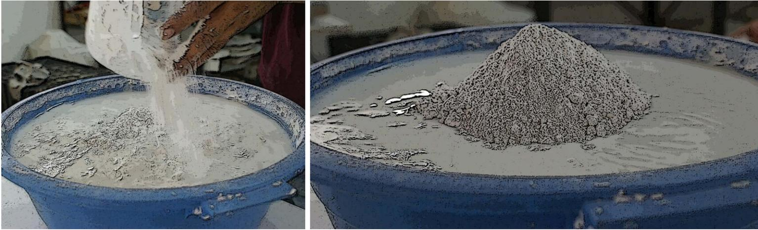
Imagen tomada de: <http://www.ceramicatrespiedras.com/cursos/tecnicas/molde-de-yeso-de-2-partes> Cómo hacer un molde de yeso o escayola de 2 partes
