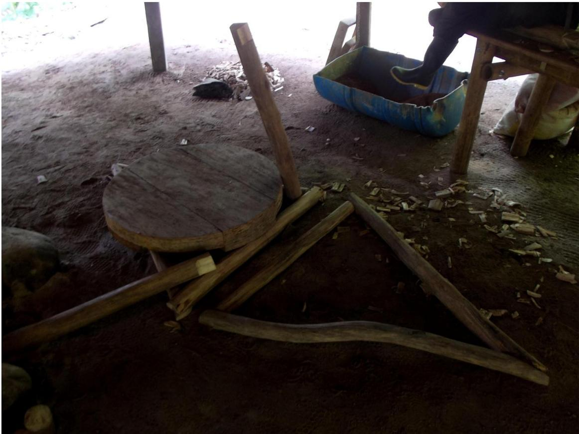
Se pre-ensambla la estructura del torno, junto con el plato de madera inferior para tomar medidas, rayar y asegurarse de las disposición de todas las partes para no cometer errores.
