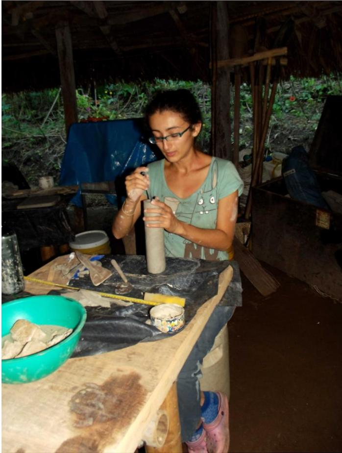
Realización de soportes, ladrillos y placa refractarios para utilizarlos en las futuras quemas en el horno de cerámica en el ensueño. Ya que la fabricación de los soportes se realizaron una semana antes de la quema, no alcanzaron a tener el secado necesario para poderlos meter al horno a quemar para luego usarlos en la mejor distribución de las piezas en las siguientes quemas
