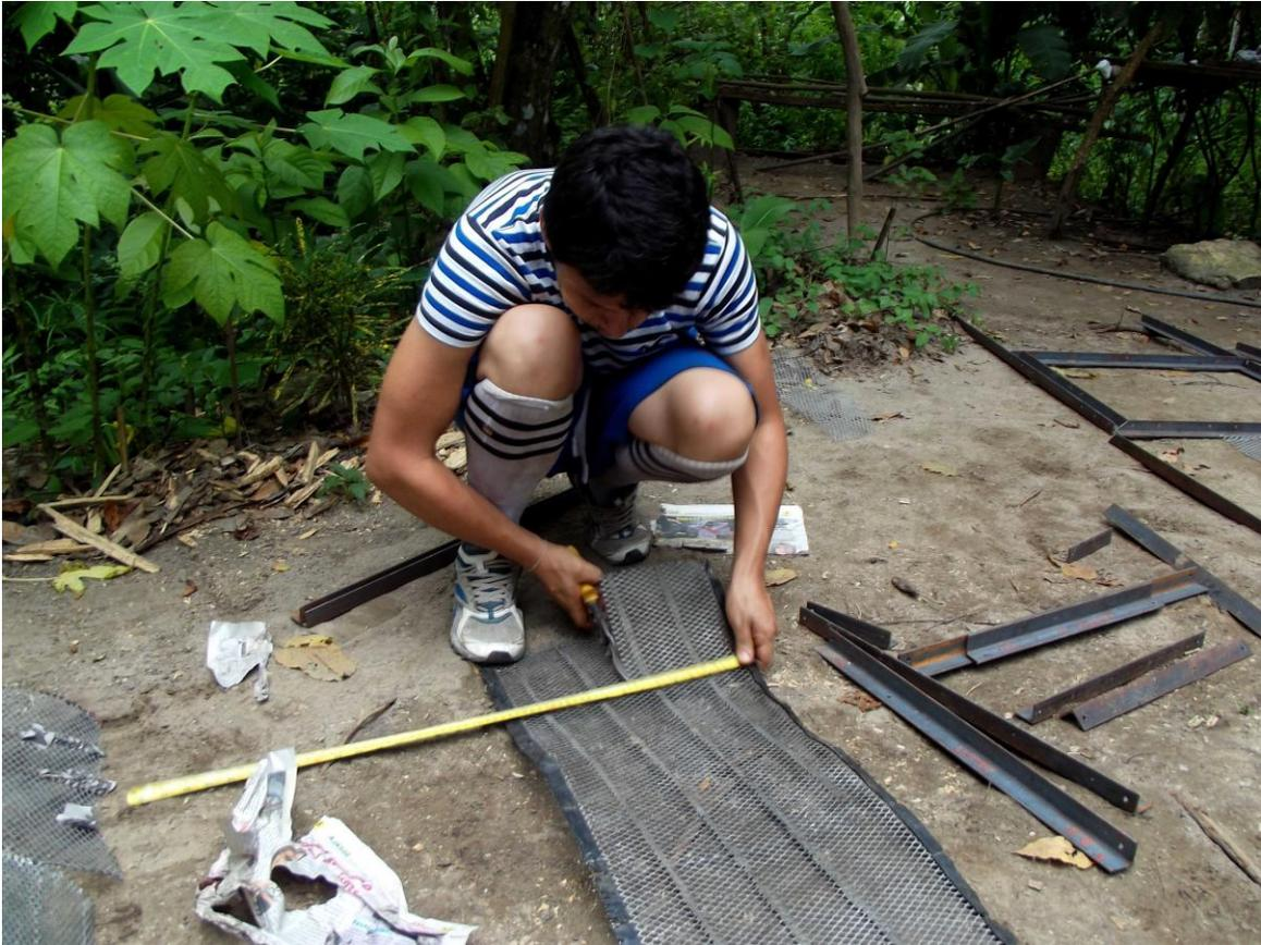
Después de ubicar las diferentes piezas metálicas según el diseño y medidas, y no volviéndolas a mezclar, se entraba a cortar la malla metálica que correspondería a cada conjunto de piezas.
