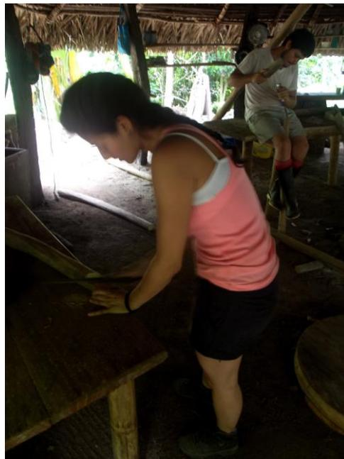
Continuamos con las medidas, corte, talla, lijada, pulida y ensamblada de los troncos de madera que servirán de estructura para el torno
