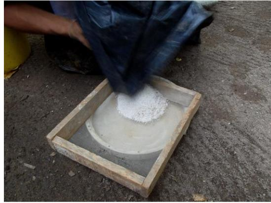
Picando cuarzo que encontramos en el río, para mezclarlo a la arcilla para que le de mayor resistencia a choques térmicos, baje la temperatura de cocción y menor contractilidad.
